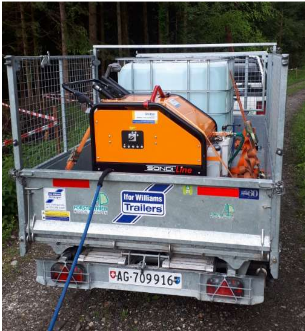
Das Heisswassergerät Sondi WeedKiller der Firma Grütter GmbH sowie der erforderliche Wassertank kann einfach auf einem Anhänger mitgeführt werden.
