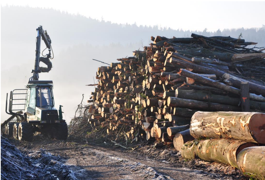
Polterung von Energieholz mit dem Forwarder (Foto: Daniel Gautschi)
