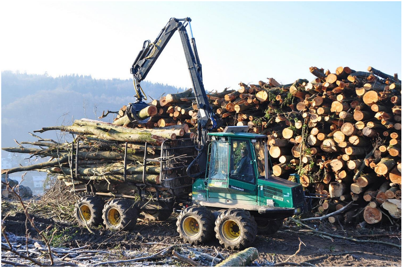
Transport von Hackholz mit dem Forwarder an die LKW-befahrbare Waldstrasse (Foto: Daniel Gautschi)
